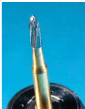
5 Usure par éclatement d'une fraise transmétal suite à un travail axial.
